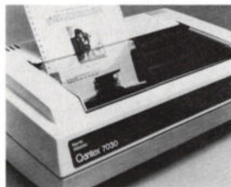
Afb. 13. De model 7030 matrix printer heeft in de grafische mode een oplossend vermogen van 144 \times 144 punten per inch.
