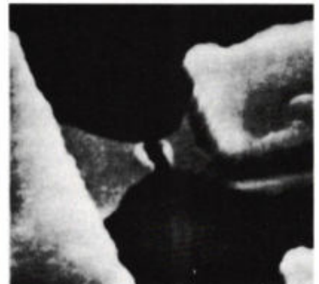
Afb. 3. Met een raster-elektronenmicroscop gemaakte opname van een in een FPL-schakeling doorgebrand doorverbindingsbrugje.
