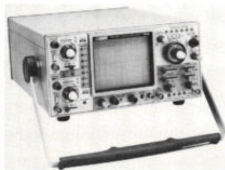
Afb. 7. De model 1590 van B&K-Precision is een vier-kanaals oscilloscoop die over de gehele bandbreedte van 100 MHz een gevoeligheid heeft van 1 mV/div.
