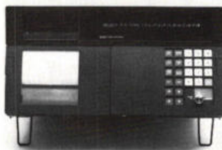
Afb. 1. De Fluke 2280 data logger beschikt over max. 1500 ingangskanalen.
