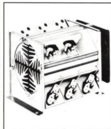
Aggregaat van Seifert voor geforceerde lucht-koeling van een aantal vermogenshalfgeleiders (foto: Clotis Nederland BV).
