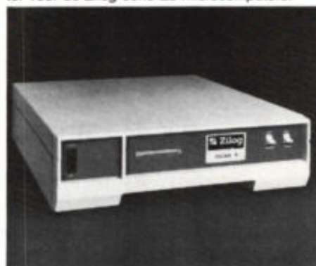
Afb. 12. De ZSCAN-8 is een in-circuit emulator voor de Zilog serie Z8 microcomputers.
